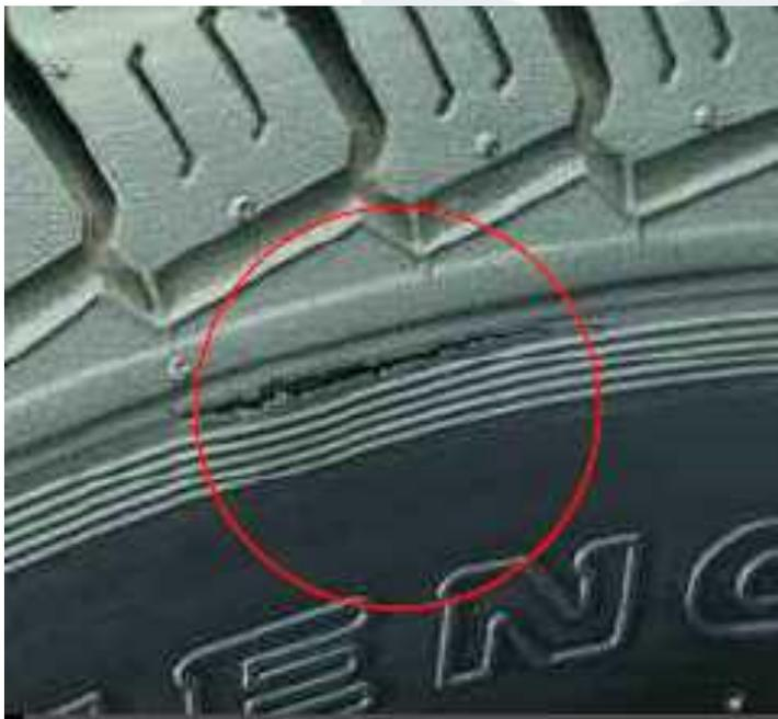
· *Cortes. Se ven los cables. Causas posibles: corte accidental debido a un objeto cortante. Los cortes se pueden percibir también sobre la banda de rodadura, siendo igualmente muy peligroso.*
