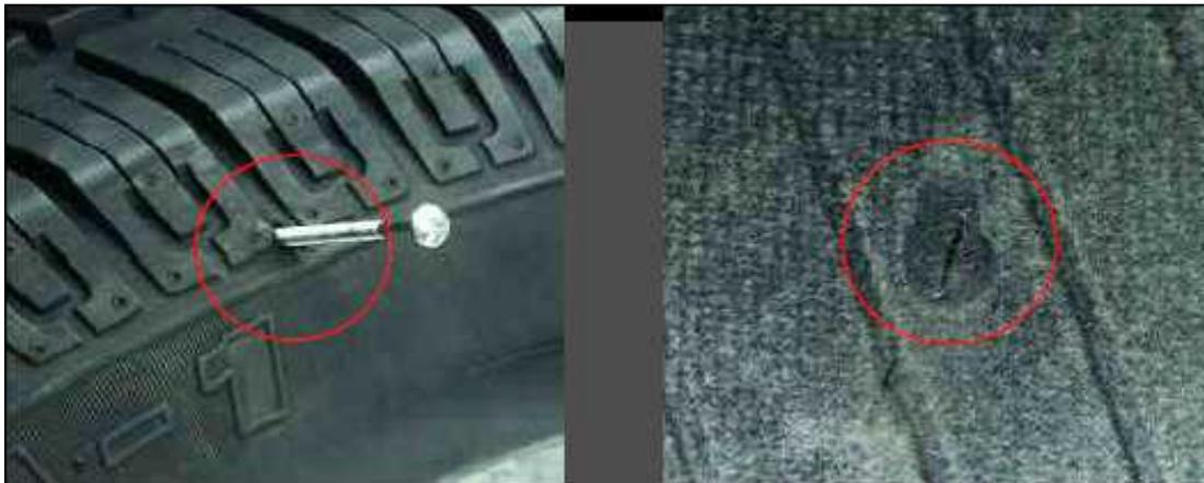
*· Neumático con baja presión de inflado: Se muestra una marca de rozamiento a lo largo de todo el neumático en la parte exterior y en la parte interior se observan arrugas en la goma.*
