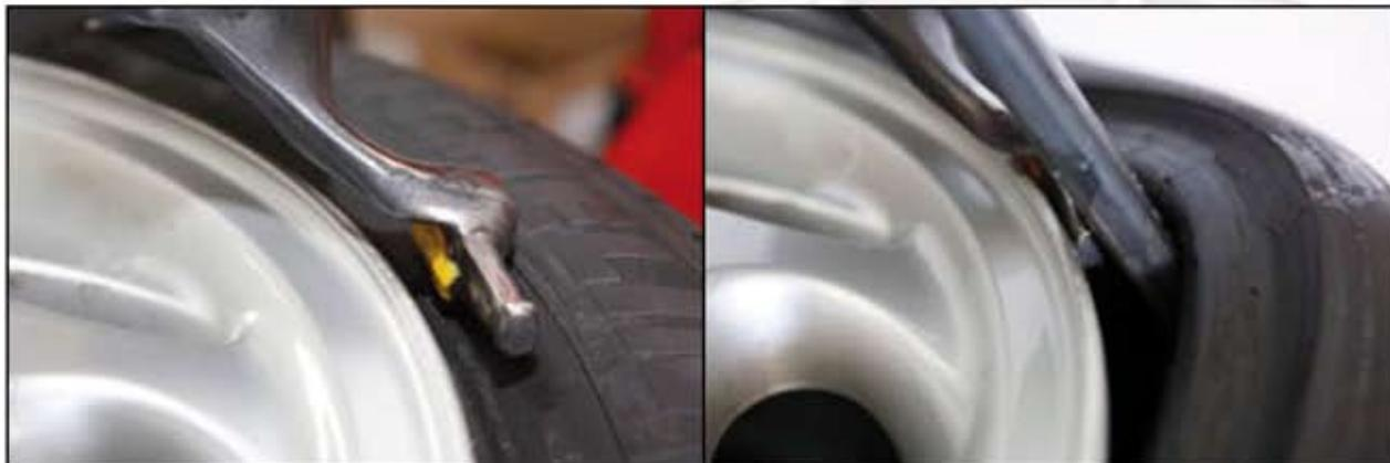
En la primera foto podemos observar, la separación que cualquier taller da a su uña de hierro para no rayar ninguna llanta de aluminio. Aun así, tal y como vemos en la segunda, aun permaneciendo esa separación, la fuerza del desmontable y la dureza de los neumáticos actuales, hacen que la uña de hierro roce.
