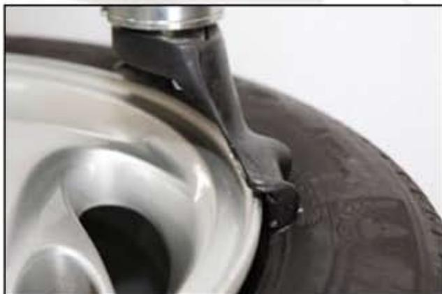
Utilizamos nuestra uña de plástico de fácil montaje, la cual está continuamente en contacto con la llanta y con ello evitamos que la uña llegue a romperse y ante todo que no raye la llanta.
